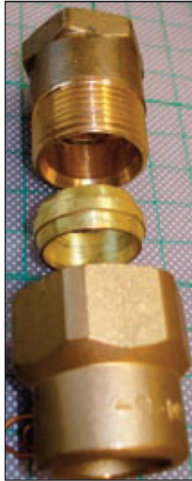
Knelfitting type AARDGAS Wartelmoer met lange nuttige steunlengte
