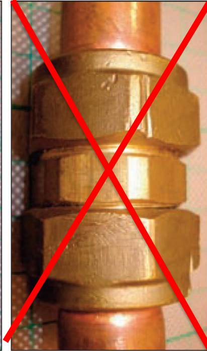
Knelfitting type WATER Wartelmoer met korte nuttige steunlengte VERBODEN VOOR AARDGAS
